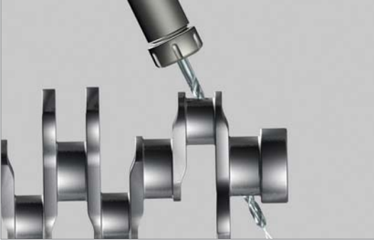
Yağlama kanalı - Mach Uzun Matkap(MLD)
